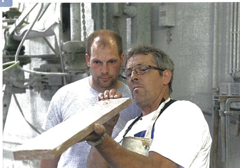
Steinmetzmeister Andreas Zieglmaier prüft die Fläche im Gegenlicht.
