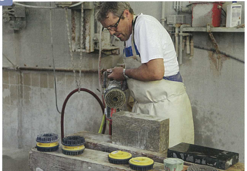
Siegfried Trambo wechselt von der Diamantbürste auf eine Satinierbürste.
